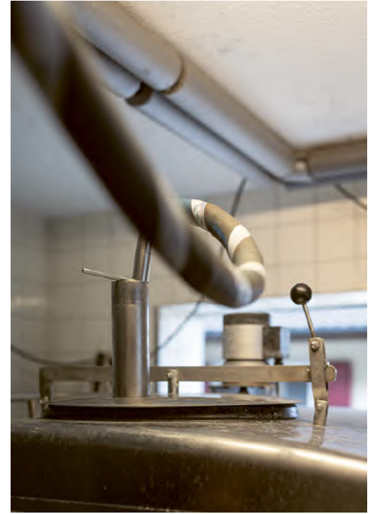
Die Milch fliesst über die Leitung in den Milchtank. ▼
